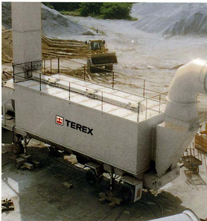
Резкое изменение направления движения воздуха внутри инерционного сепаратора приводит к улавливанию более тяжелых частиц из потока отходящих газов.
